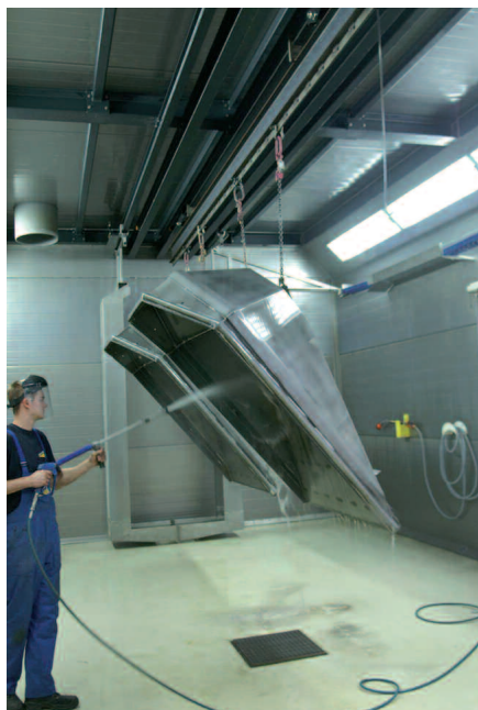
Die großen Werkstücke werden in der Waschkabine manuell mittels Hochdrucklanze gereinigt, für die kleineren ist die Kabine mit einem automatischen Sprühkranz ausgestattet.
