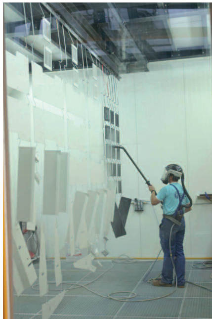
Der Auftrag des Pulverlacks erfolgt manuell in der Großraum-Pulverspühkabine mit Unterflurabsaugung. Die Kabine wurde auf Verlust im Vielfarbenbetrieb ausgelegt, um kurze Farbwechselzeiten von max. 5 min zu realisieren.
