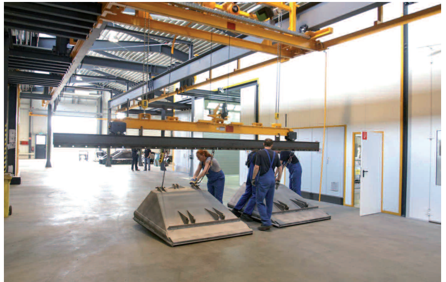
Verbindendes Element zwischen beiden Linien ist die elektrisch angetriebene Querfahrbühne mit einer Tragkraft von max. 4000 kg mit der mobilen Hub- und Senkstation.
