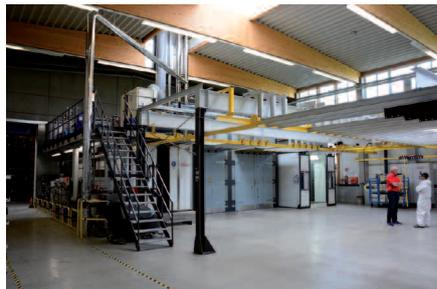
Die Anlage im Überblick, von links: Vorbehandlung, Haftwassertrockner, Einbrennofen, Pulverkabine. In der 2. Ebene befinden sich die Technik für die Vorbehandlung und die Abluftanlage.
