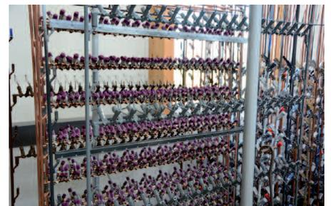
Für die Profile, Blenden und Halterungen verfügt Reflexa über Warenträger, die in die Traversen eingehängt werden.
