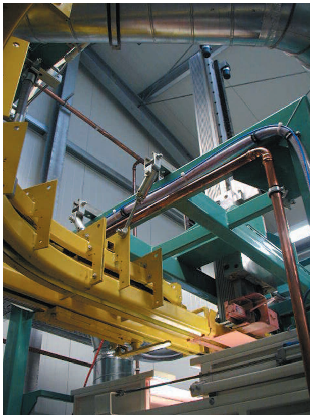
Knackpunkt Senkstation: In weniger als zwei Sekunden je zwei Beschleunigungs- und Bremsrampen bei 1G Beschleunigung von 250kg Masse
