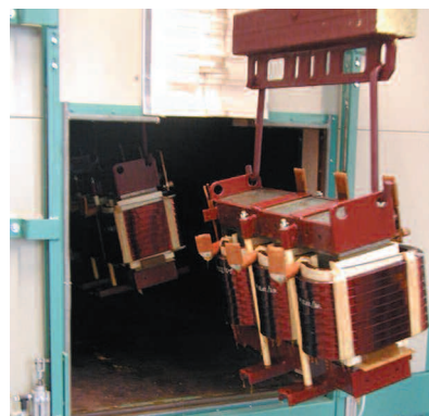
Nach dem Sintern erfolgt die endgültige Vernetzung im Aushärteofen
