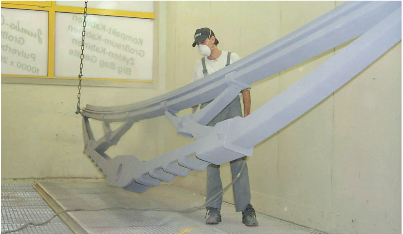
Kostengünstige Handbeschichtung in der begeh- und befahrbaren Großraumkabine
