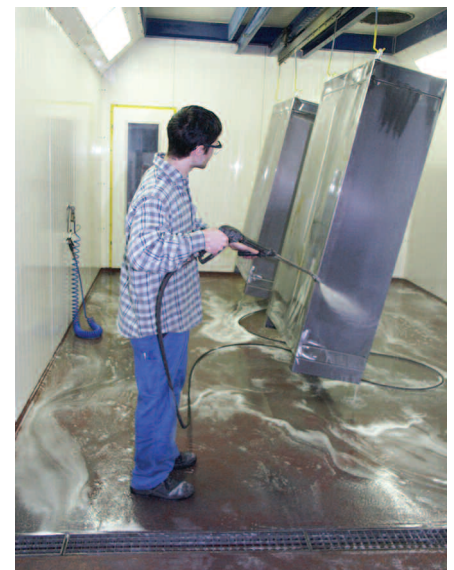
Vorbehandlungskabine: Wasserdampf wird durch eine wirkungsvolle Schwadenabsaugung im hinteren Teil der Kabine abgesaugt
