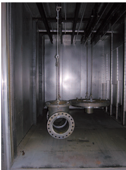
Am Ofen befinden sich für jede der fünf Schienen im Ofen eine Zeituhr, mit der der zeitliche Ablauf der Trocknung gezielt kontrolliert werden kann.
