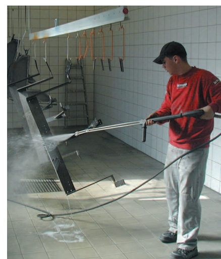
Manuelle Vorbehandlung garantiert, dass auch Problemzonen der Werkstücke über eine einwandfreie Lackhaftung verfügen
