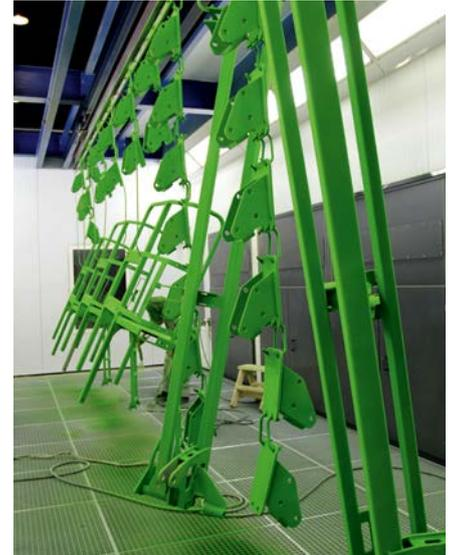
Die pulverbeschichteten Teile und Baugruppen werden über den Verschiebebahnhof „rangiert“, der kundenspezifisch für Amazone in Samara geplant ist. Quelle: Amazone
