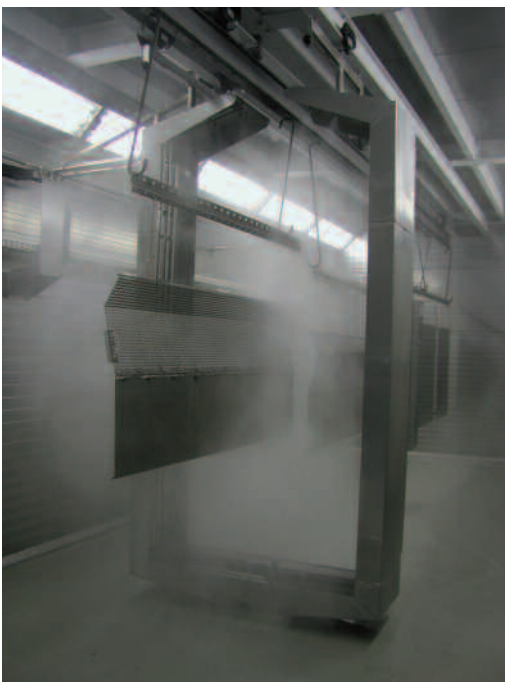
▲ Halbautomat2: Normalerweise Hansbeschichtung, für höchste Qualität von flachen grossflächigen Teilen steht die Auslaufschleuse mit Beschichtungsautomat zur Verfügung
