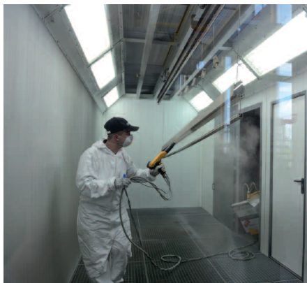
Die Luft wird vertikal geführt und erlaubt die Applikation von zwei Farben pro Traverse.
