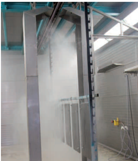
Die Reinigung und Phosphatierung kann automatisiert durch einen Sprühkranz oder bei breiteren Bauteilen mit einem Handgerät erfolgen.
