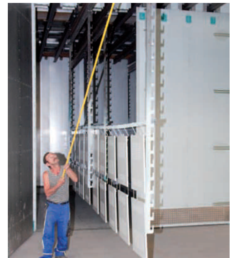
Die Lackieranlage greift, wo es möglich ist, auf die Abwärme der Blockheizkraftwerke zurück - zum Beispiel für den Haftwassertrockner oder die Lackierkabinen. Auch das Vorbehandlungsbad wird über einen Plattenwärmetauscher geheizt.
