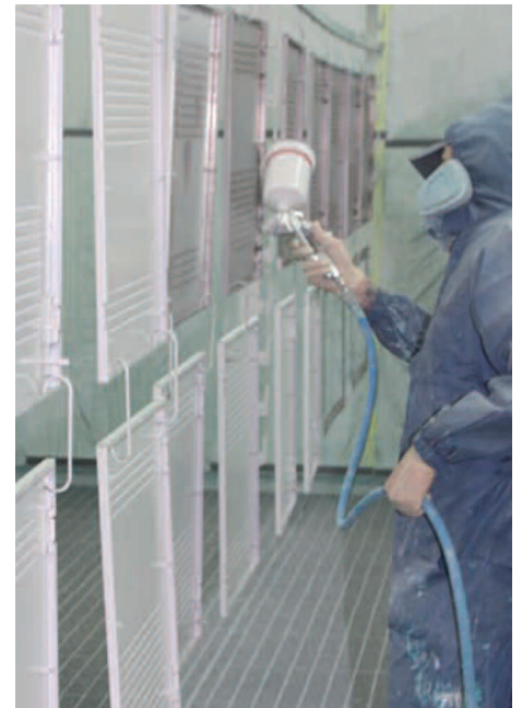
Die JUMBO-COAT-Anlage verfügt über zwei Nasslack- und eine Pulversprühkabine, bis zu 8 Meter lange und 3 Meter hohe Teile können beschichtet werden. In den Nasslack-Kabinen kann bei Bedarf mit bis zu 80°C getrocknet werden.
