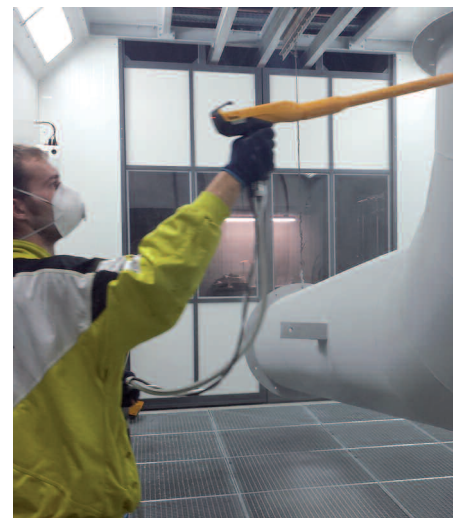
In der Pulverkabine wird die Luft vertikal über eine Absaugung unter den Gitterrosten aus der Kabine geführt Foto: Feuerverzinkung Meyer
