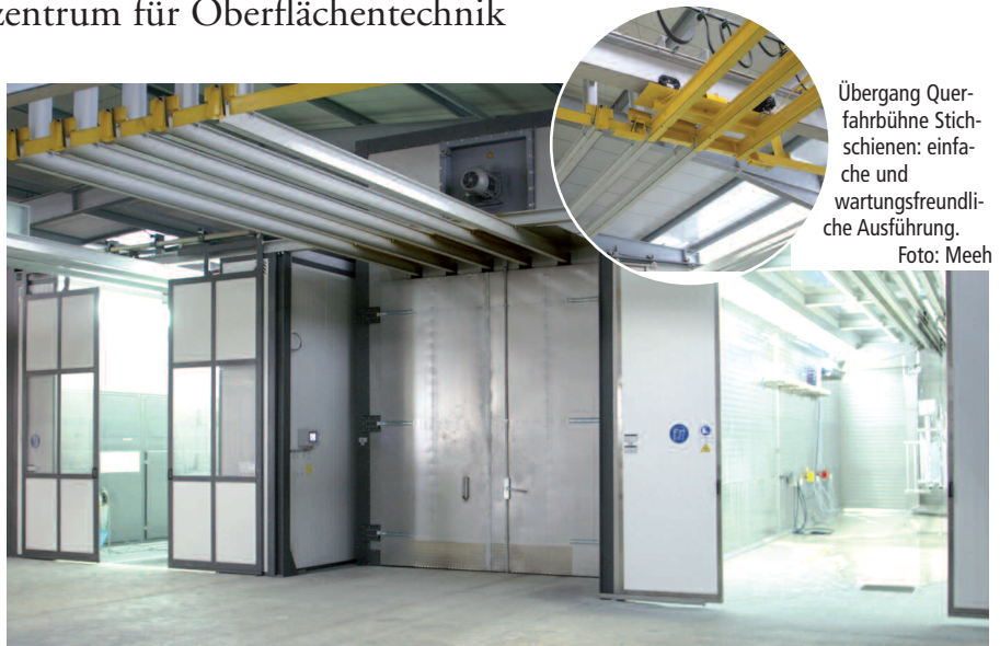
Die Waschkabine (rechts) ist für die Vorbehandlung von Werkstücken mit einer Länge bis zu 14 m möglich. Foto: Meeh
