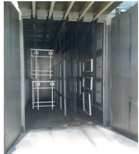
Flexible Nutzung: Der Haftwassertrockner kann auch zum Einbrennen des Pulvers genutzt werden. Foto: Meeh
