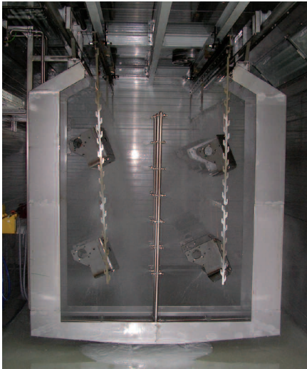
Der Sprühkranz kann bei Bedarf mit einer Mittel-Lanze zum gleichzeitigen Waschen von zwei Traversen geteilt werden. Foto: Meeh
