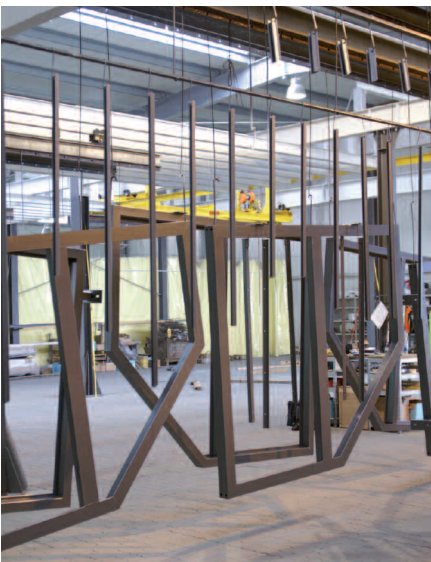
Das Unternehmen beschichtet für Schlossereien und Fensterbauer sowie für Unternehmen aus den Bereichen Anlagen-, Maschinen- und Fahrzeugbau in den Korrosionsschutzklassen C4 und C5. Foto: Meeh
