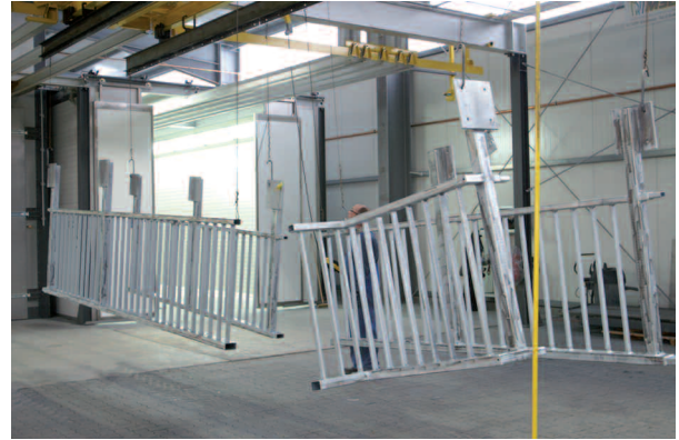
In den Stichschienen erfolgt der Transport der Traversen manuell, in der Querfahrbühne elektrisch Foto: Meeh
