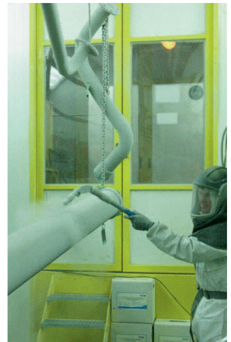
Die Werkstücke werden elektrostatisch gepulvert. Der Overspray wird über eine vertikal geführte Zu- und Ablufttechnik zuverlässig absaugt und zum Zyklonabscheider gefördert.
