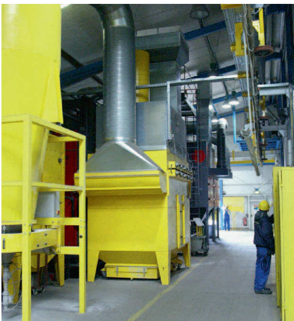
Mit der rund 70 m langen Anlage kann das Unternehmen in 24 Stunden rund 350 Bauteile strahlen, reinigen, lackieren und trocknen. Links: Zyklon-Pulverrückgewinnung und Nachfilter
