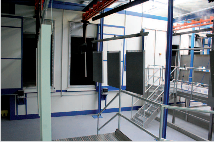
Haftwassertrockner und Einbrennofen als Kombi-Einheit: Ein Brenner für zwei Komponenten ist nur durch raffinierte Wärmeverteilung und ausgeklügelte Luftführung möglich und ermöglicht eine optimale Ausnutzung der Energie.
