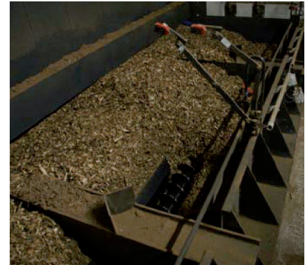
Die Hackschnitzel werden über einen Schubboden und mehrere Schnecken in die Öfen gefördert.
