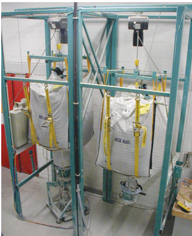
Pulversversorgung ab BigBag im Doppelpack
