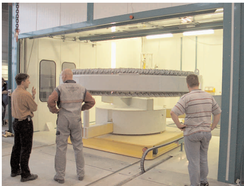
Präzisionsarbeit: Das Platzieren der Werkstück auf dem hydraulischen Aufnahmetisch mit Bodenförderer für den Transport in die Großkabine
