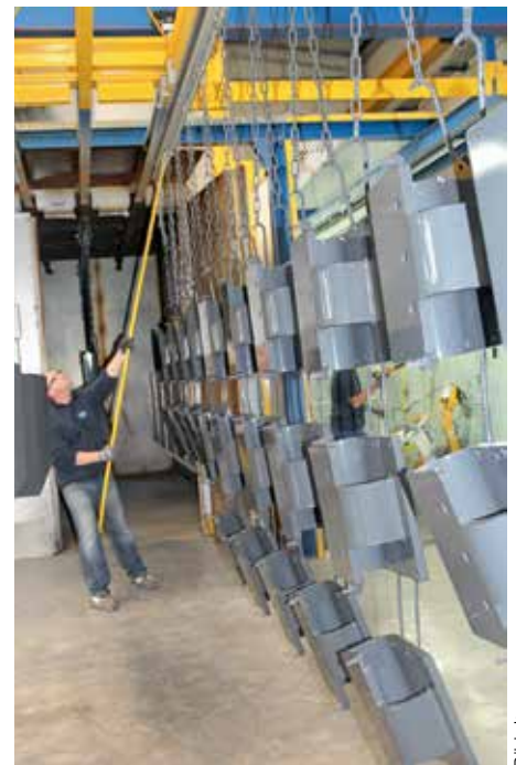
Auch nach dem Einbrennen des Pulverlacks dient der Parkplatz zum Abkühlen.
