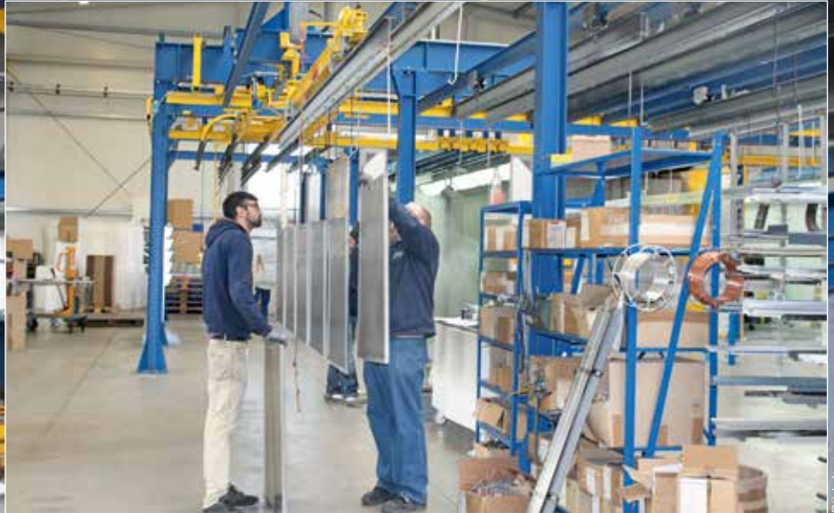
Werkstückaufgabe: Die Blechteile werden an der Hub-Senk-Station auf die Warenträger gehängt.
