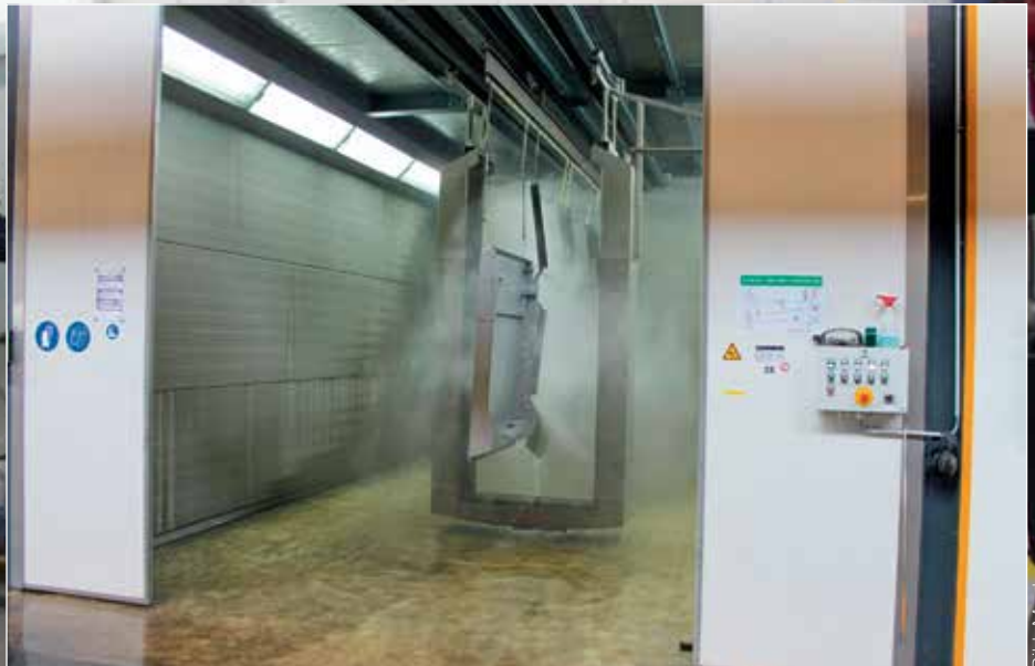
Vor dem Beschichten werden die Teile mittels JUMBO-CLEAN-Waschautomat gereinigt.
