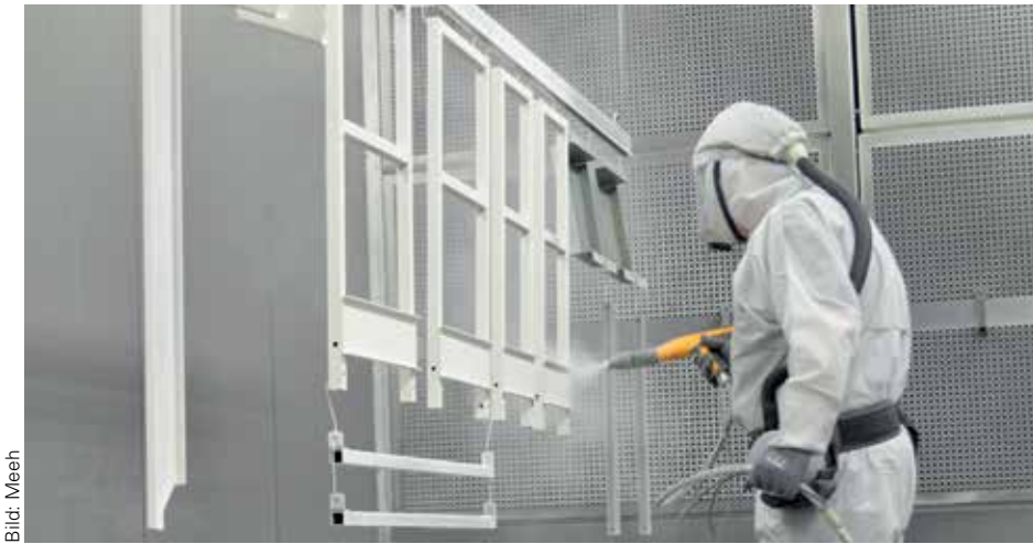
Die elektrostatische Beschichtung erfolgt manuell.
