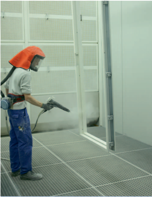
Die Luftführung erfolgt quer von der offenen Kabinenseite zur geschlossenen Rückwand, die als Lochwand mit dahinter liegenden, selbstreinigenden Filterpatronen ausgeführt ist
