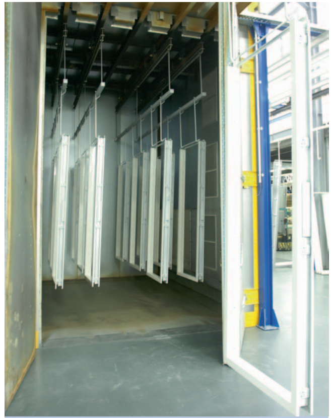
Für das Angelieren und Einbrennen können die fünf Schienen im Ofen jeweils separat gesteuert werden
